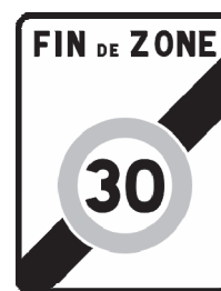
Panneau B51 indiquant la sortie d'une zone 30
