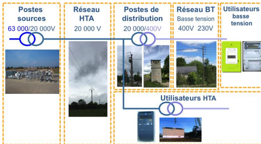
Figure 96 : Architecture du réseau public de distribution d'électricité
